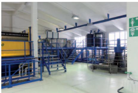
Blick in das wieder errichtete Obergeschoss mit Filterpressen und Durchlaufanlage
