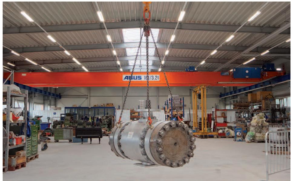
Die neue Fertigungshalle ist technisch hochwertig ausgestattet. Das Herzstück bilden zwei funkfern-gesteuerte Zweiträgerlaufkräne.
