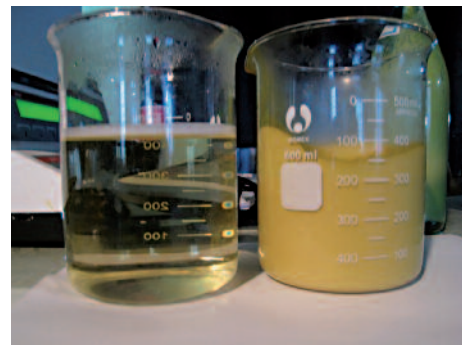
Filtrat (links) und Konzentrat nach der Filtration von Destillationsrückständen bei der Herstellung von Ethanol aus Mais.
