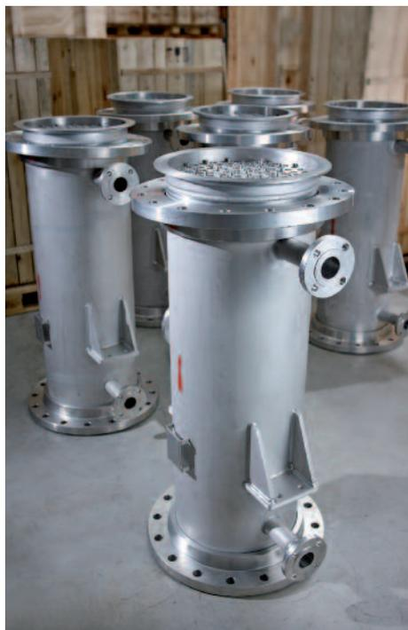
6 der insgesamt 10 nach Kanada gelieferten Moduln, die dort in der Filtration von Produktionswasser aus der hydraulischen Fraktionierung im Bereich der Förderung von Erdöl und Erdgas eingesetzt werden. © Christoph Fein (2014)
