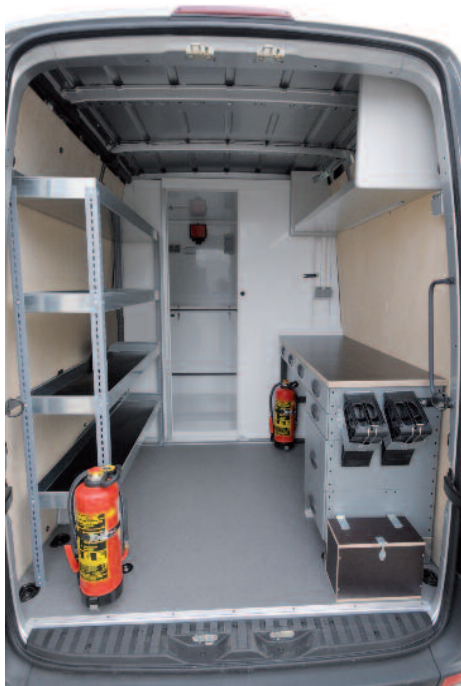
Laborfahrzeug für mobile Durchstrahlungsprüfungen mit komplett eingerichteter Dunkelkammer inklusive Filmtrockner sowie einem Arbeitsplatz für Filmauswertung und Dokumentationserstellung
