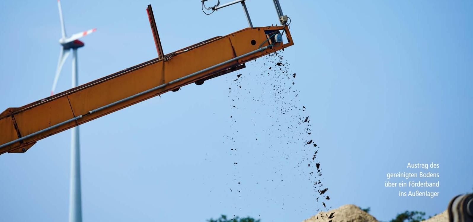
Austrag des gereinigten Bodens über ein Förderband ins Außenlager
