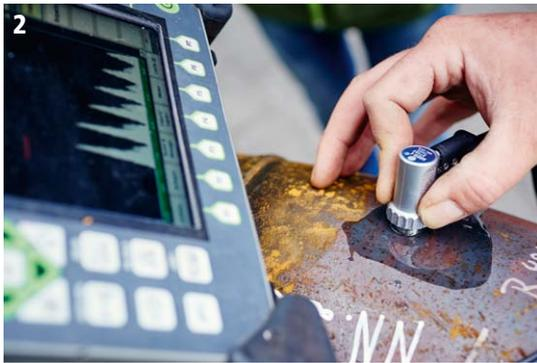
Parallel konnte das Spektrum an Prüfungen durch die neuen Mitarbeiter deutlich erweitert werden. So wurde zum Beispiel die konventionelle Ultraschallprüfung durch die modernste Ultraschall Phased-Array-Technik ergänzt. Dieses bildgebende Prüfverfahren ist aus der Medizin bekannt und hat jetzt Einzug in die zerstörungsfreie Prüfung gehalten. Für den Chempark in Dormagen wurden 3 weitere Prüffahrzeuge sowie ein weiterer Laborwagen angeschafft.
