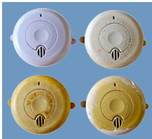
Verschmutzungen können zu Fehlalarmen bei Rauchmeldern führen: Oben links ein neuer Rauchmelder, rechts daneben ein durch Fliegendreck verschmutzter, unten links ein durch Zigarettenrauch verunreinigter, unten rechts ein überstricher, ebenfalls aus einer Raucherwohnung
