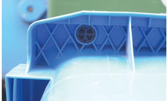
An dieser Papiertonne der GER ist der Transponder unterhalb der Öffnung angebracht.
