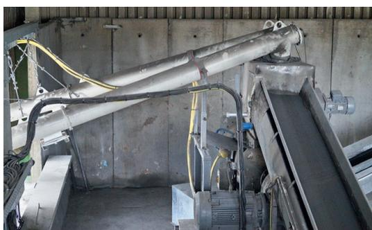
Das im Silo zwischengelagerte Material wird über eine Flügelrad schleuse der Förderschnecke zugeführt.
