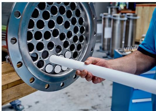
Ein Druckgehäuse wird mit Membranen bestückt – so entsteht ein Modul einer Filtrationsanlage.
