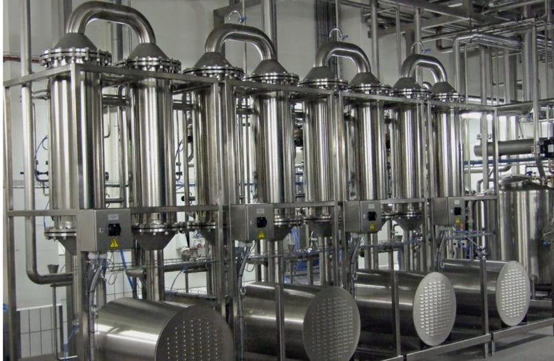
Anlage zur Abtrennung von gefälltem Calciumphosphat zur Verwendung in der pharmazeutischen Industrie
