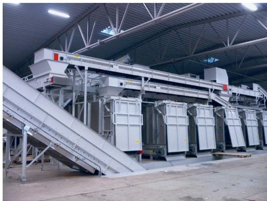
Swerec verfügt über die größte und modernste Kunststoffrecyclinganlage Skandinaviens; im Bild die Bunker für die einzelnen Fraktionen und das Förderband, das diese zur Ballenpresse befördert.
