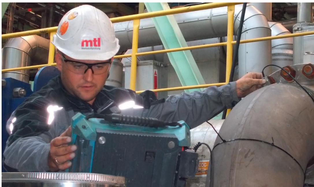
mtl-Mitarbeiter Miroslaw Kretosz bei einer Phased-Array-Prüfung an einer Rohrleitung
