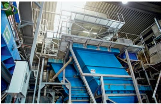
In den Lamellenklären sinken die ausgeflockten Schadstoffe auf den Boden und werden dort abgepumpt
