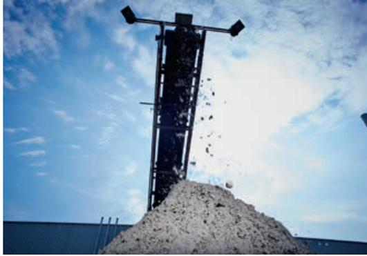
Der gereinigte Boden gelangt in den Weißbereich zur anschließenden Verwertung...
