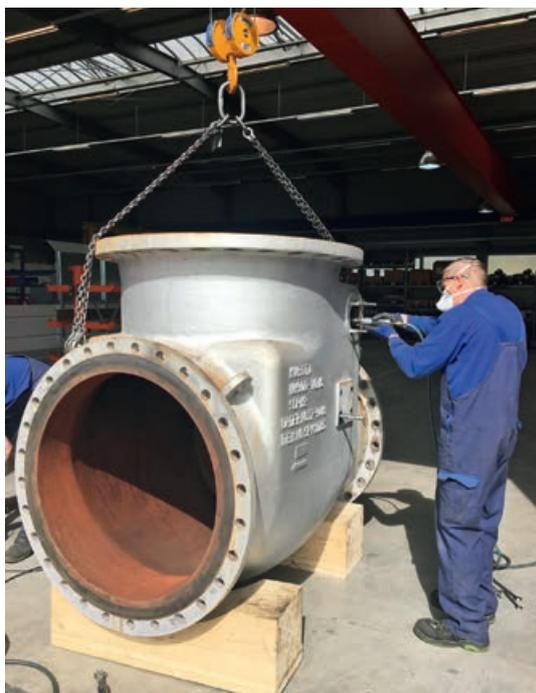
Gehäuse eines Absperrschiebers DN900 in Überarbeitung
