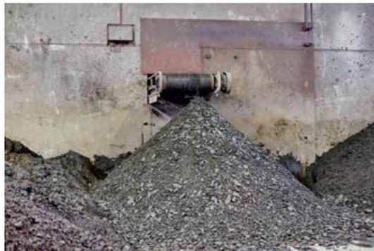
...und die Verunreinigungen werden als Filterkuchen in den Schwarzbereich ausgetragen zur anschließenden Beseitigung
