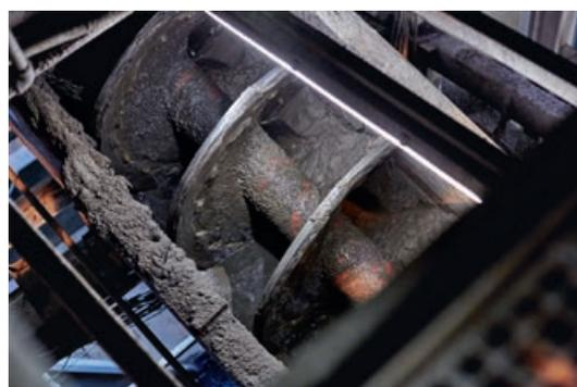
In der zweiten Reinigungsstufe wird der verunreinigte Boden mittels einer Reinigungsschnecke erneut mechanisch behandelt und durch die Reibungsenergie aufgeschlossen
