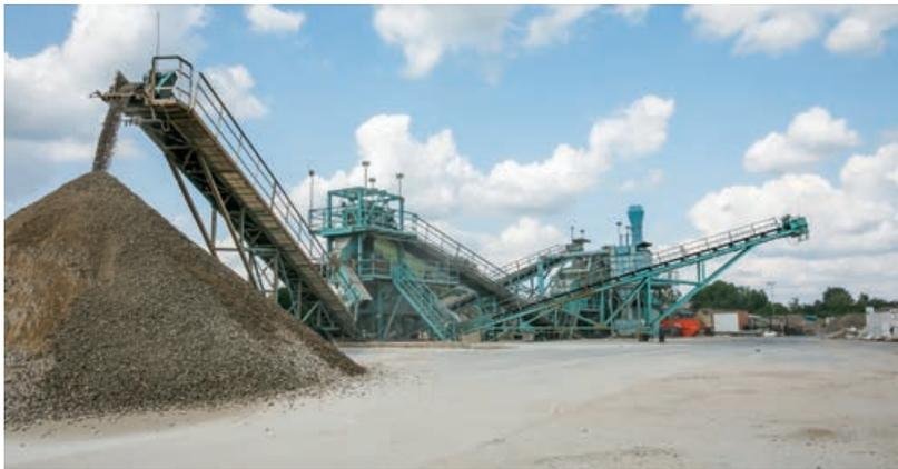
Brechanlage des stralab-Kunden BVO in Rüdersdorf. Das Abbruchmaterial wird zerkleinert, gesiebt und zu einer homogenen Korngrößenverteilung aufgearbeitet.
