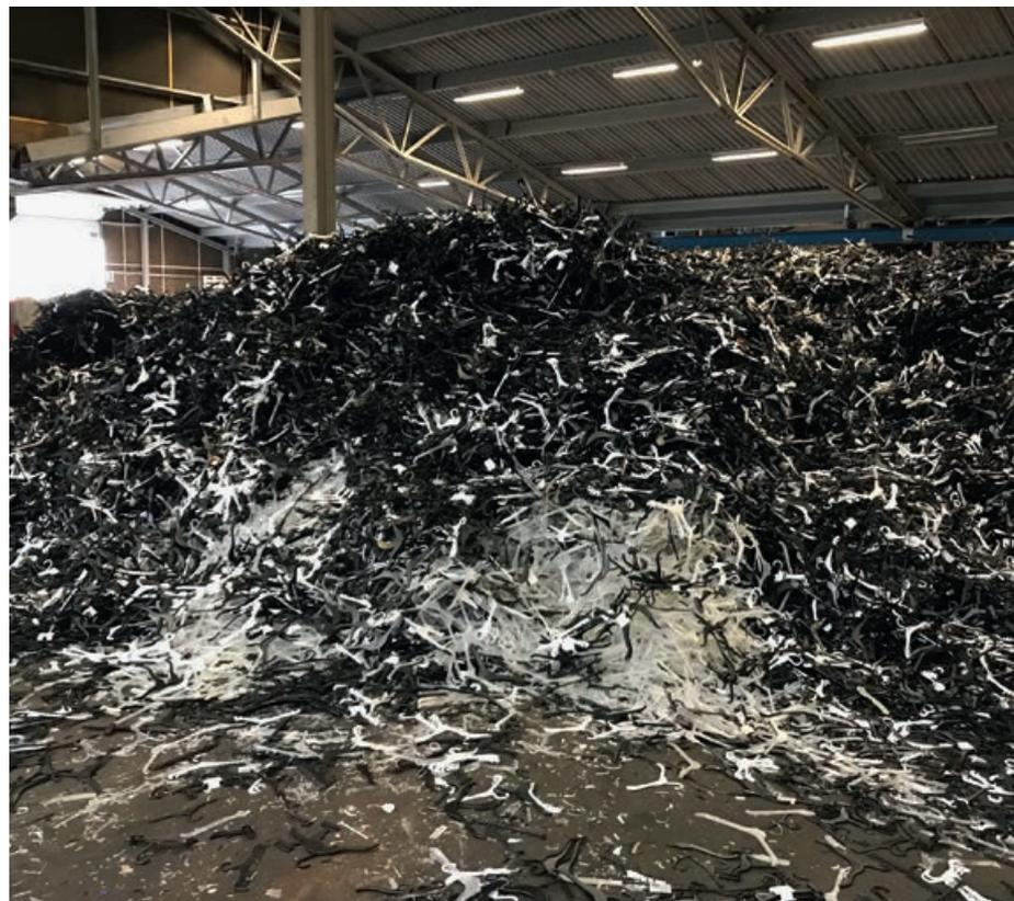
Große Mengen an Kleiderbügeln von einem bekannten Textilunternehmen. Swerec mahlt und wäscht das Material, anschließend wird die Polystyrolfraktion in spezialisierten Unternehmen zu neuen Produkten weiterverarbeitet.
