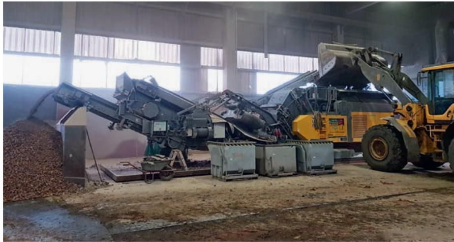
Da der Brecher in einer geschlossenen Halle betrieben wird, ist die obligatorische Staubentwicklung beim Brechen ein besonderes Thema. Zusätzlich zur Brecher-eigenen Staubbeseitigung durch Wasserdüsen wird derzeit eine Absaugung der Materialaufgabe mit separater Entstaubungsanlage verwirklicht.
