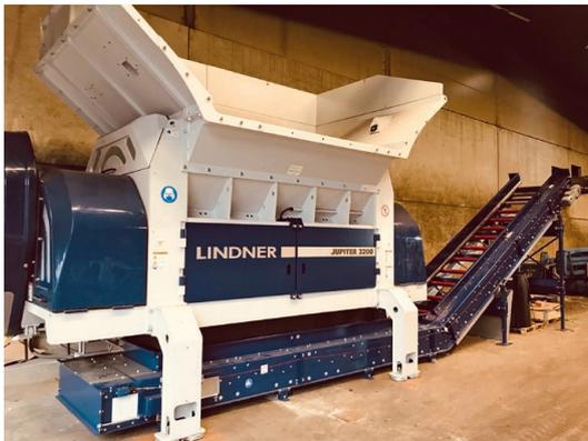
Der neue, leistungsfähigere Vorzerkleinerer kann die Öffnung von Ballen sowie die steigende Menge Kunststoffabfallsäcken aus festem Material besser bewältigen
