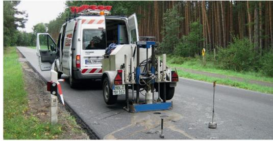
Hier werden von der stra/lab Bohrkerne mit Hilfe des Bohrergerätes entnommen
