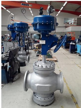
Regelarmatur DN 300 eines Kunden mit Antrieb
