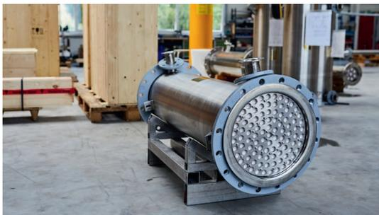
Ein Edelstahlmodul bestückt mit keramischen Membranen kurz vor dem Verpacken in eine Versandkiste.
