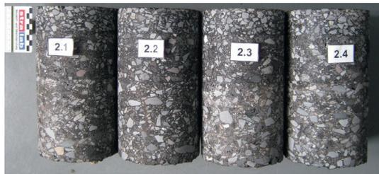
Bei einer Kontrollprüfung werden je Messstelle 4 Bohrkerne entnommen und im Labor fotografisch dokumentiert. Im nächsten Schritt erfolgt die Schichtdickenmessung der jeweiligen Schichten. Die dargestellten Bohrkerne bestehen aus 3 Schichten: Tragschicht, Binderschicht und Deckschicht
