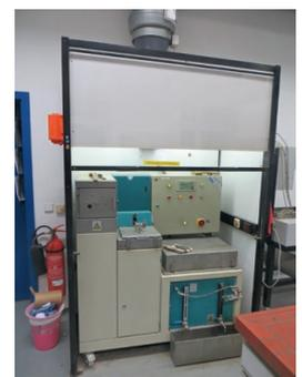
Extraktionsanlage im Labor der stra/lab zur Trennung von Gesteinskörnung und Bindemittel mittels Trichlorethen für die Überprüfung des Materials
