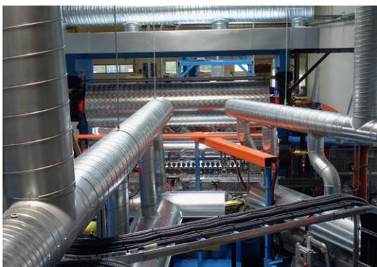
Die neue Anlage arbeitet mit zwei Extrudern, im Hintergrund die Walze, die die Struktur aufprägt
