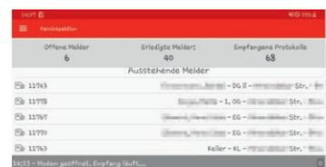
Auf dem Display von einem Smartphone oder Tablet wird der Status aller im Haus befindlicher Rauchmelder angezeigt
