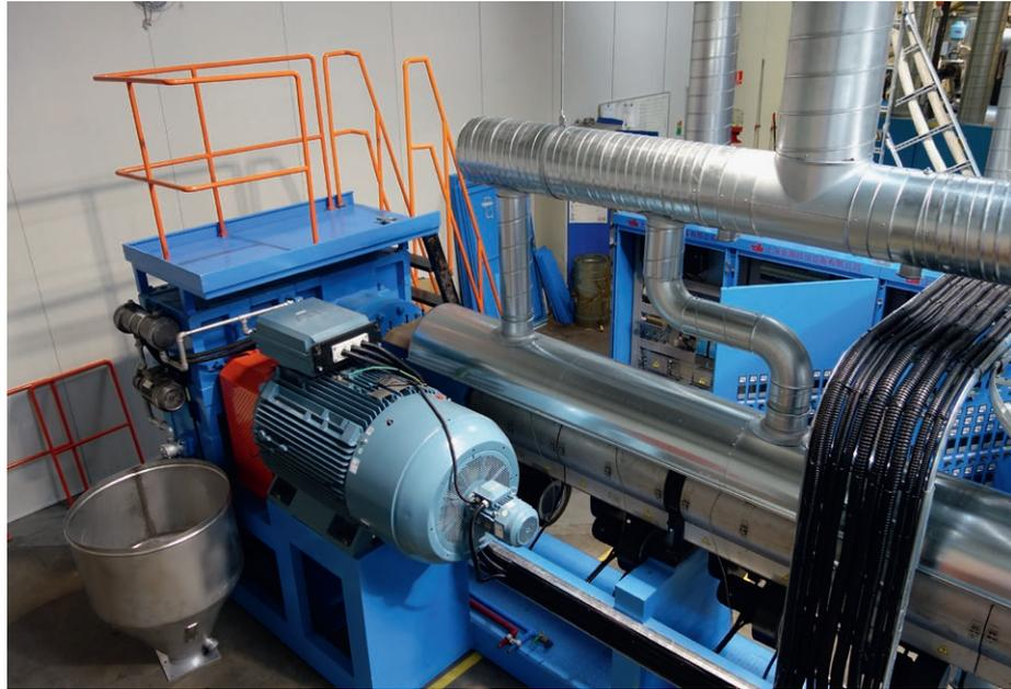
Kaum waren die Komponenten endlich im dänischen Karup eingetroffen, begann die Danrec mit dem Aufbau der neuen Produktionslinie. Im Bild ein Extruder mit Abzugshaube und Antrieb, links der noch zu installierende Einfülltrichter und im Hintergrund die Schalt-schranke mit der Steuerung.
