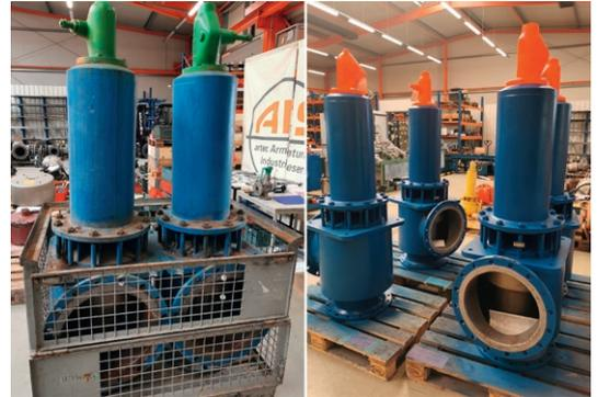
Sempell Sicherheitsventile DN400 PN10 vor (links) und nach der Instandsetzung. Die Kappenfarbe zeigt das Jahr der nächsten benötigten Überprüfung der Sicherheitsarmatur an.
