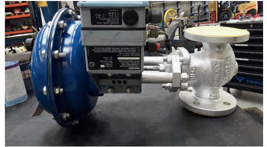
Vor der Revision (links) und danach: das Regelventil wurde mechanisch überarbeitet, Kegel und Spindel ausgetauscht, der Antrieb überholt, ein neuer Stellungsregler angebaut und eingerichtet
