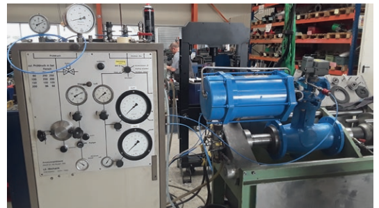
„Neuer“ gebrauchter Prüfstand mit horizontaler Spannvorrichtung im Einsatz bei artec AIS
