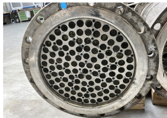
Rückkehr nach 23 Jahren: Vier dieser Module mit keramischen Membranen von atech wurden gewartet und die Membranen ausgetauscht
